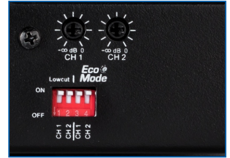
DIP-Schalter für Einzelkanalabschaltung und Low-cut. DIP-Switch for singlechannel switch off and low-cut. (ECO-Mode)
